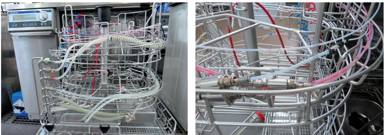
Abb. 1: RDG-E mit angeschlossenen 2000 mm PTFE-Schläuche, Ø 2 mm und Ø 1 mm
