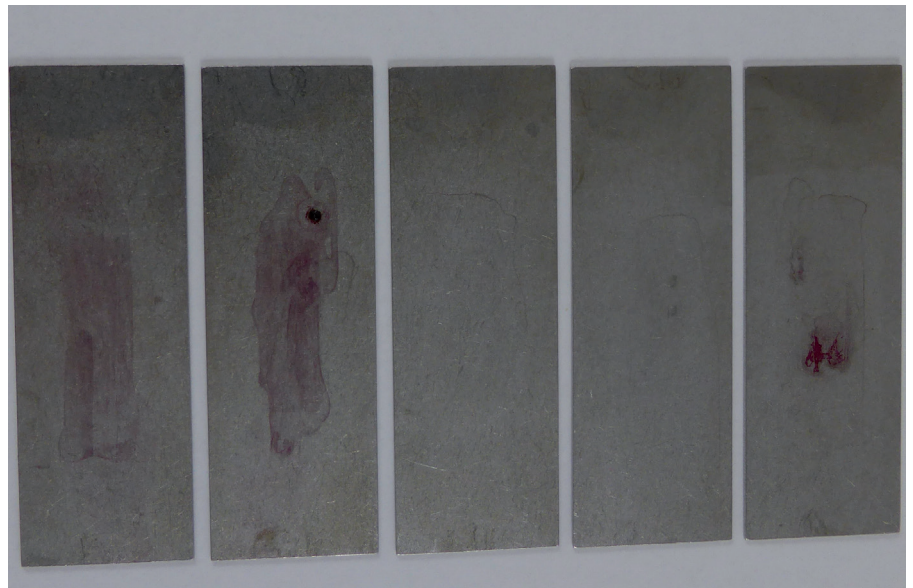
Abb. 2: 1 Minute im Ultraschallbad behandelte Prüfkörper mit koaguliertem, angetrocknetem Schafsblut nach Anfärbung mit Ponceau S.
