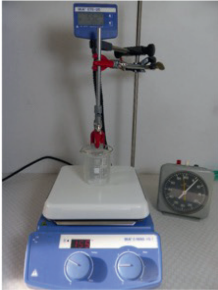
Fig. 1: Dispositivo de prueba para comprobar el efecto de la limpieza / Experiment design to test cleaning effectivity
